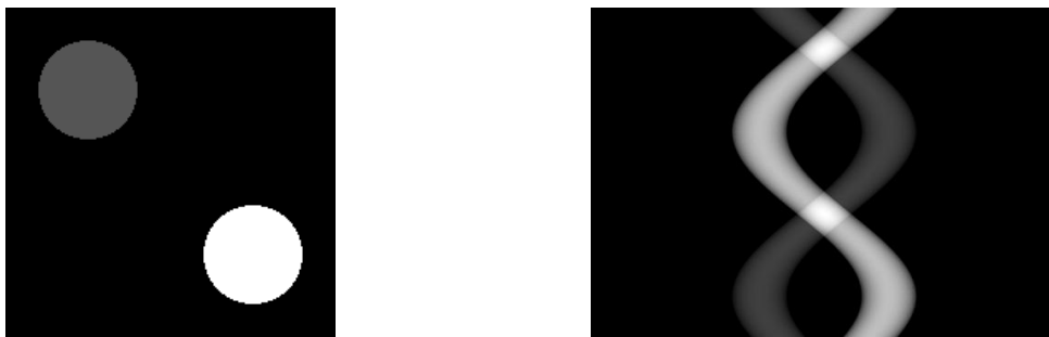
Slika 10.5: Testna slika proj2d_test.png s pripadajočim sinogramom, izračunanim s pravokotno projekcijo.
